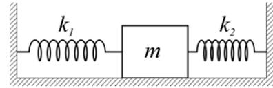
процессе. Фраза «напряжение на конденсаторе  $C_1$  максимально и равно  $U_1$ » в механическом эквиваленте означает, что пружина  $k_1$  растянута до максимального известного значения  $l_0$ . При этом напряжение на конденсаторе  $C_2$  равно нулю, т.е. пружина  $k_2$  не деформирована. Нам необходимо найти максимальное значение тока, т.е. в переводе на механический эквивалент – максимальную скорость груза.
