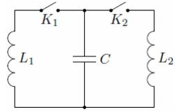
2. В схеме, показанной на рисунке, все элементы можно считать идеальными, параметры элементов указаны на рисунке. До замыкания ключа конденсаторы были не заряжены. После замыкания ключа максимальный ток в катушке равен  $I_0$ .
